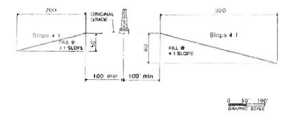
RECLAIMATION FOR LONE STAR SAND GAS WELL GRADING PLAN
